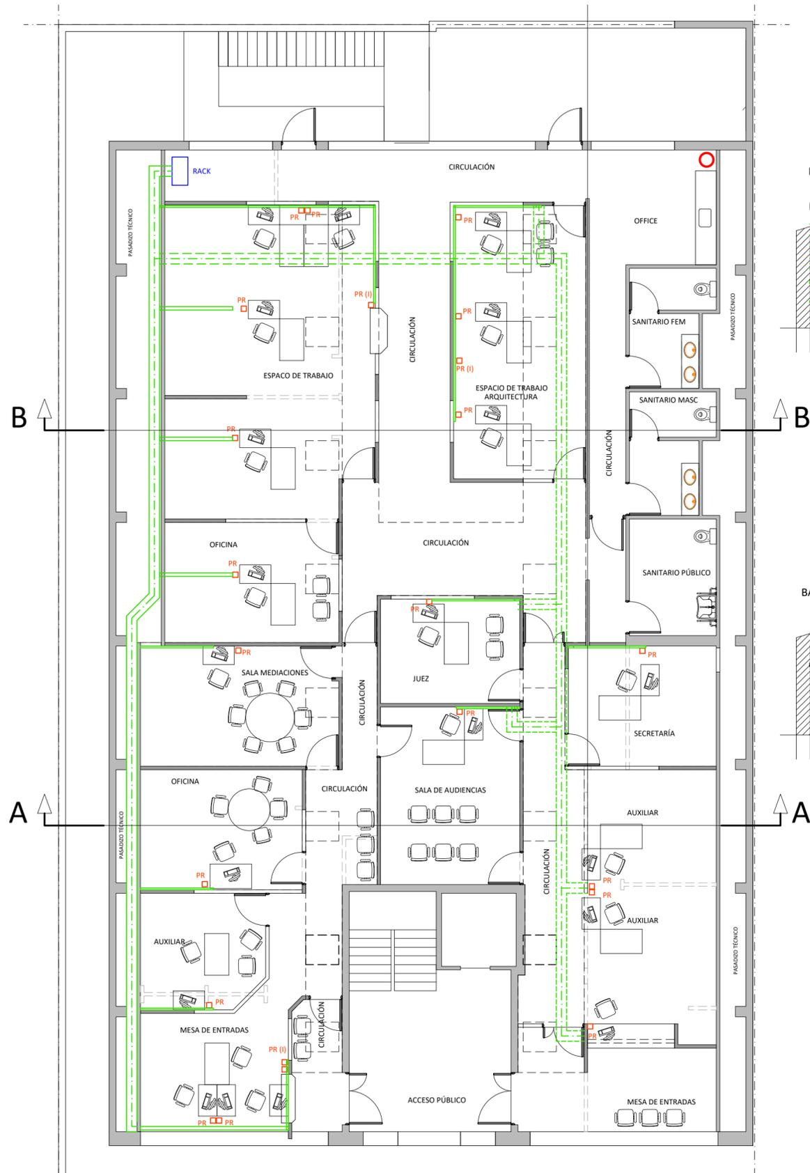
Planta Puestos de red y bandejas portables - Informática - Esc: 1:100
